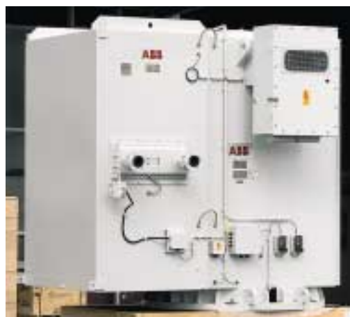
◀ Вертикальный двигатель 3,3 кВ для полупогружной буровой платформы: мощностью 3 200 кВт при 789 об/мин, 52,3 Гц.
