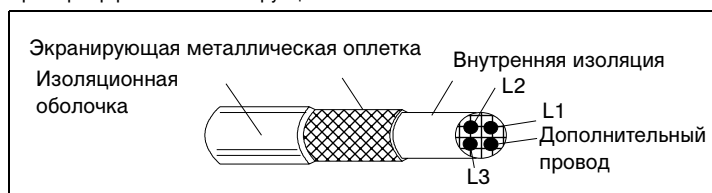
Рис. 21 Эффективное экранирование кабеля электродвигателя (например, кабели Oflex-Servo-FD 780 CP, Lappkabel или МССМК, НК ).
