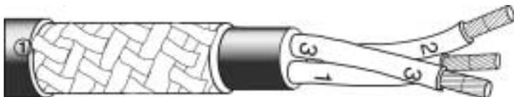
Оцинкованный стальной или луженый медный провод экраном в виде оплетки.
