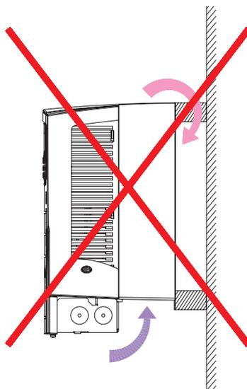
На приведенном ниже рисунке показано минимальное расстояние, необходимое для охлаждения. Необходимо предотвратить поступление нагретого воздуха от одного привода в отверстия для охлаждающего воздуха другого привода.
