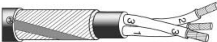
Концентрический слой медной проволоки и навитая с зазором медная лента.
