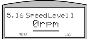
Промежуточная скорость 1 для сигнала "достигнута скорость 1"
