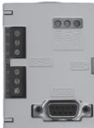
Задание параметров интерфейса панель-порт с целью внешнего управления приводом по протоколу Modbus:
