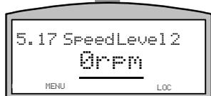
Промежуточная скорость 2 для сигнала "достигнута скорость 2"
